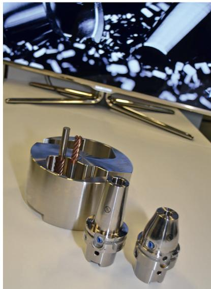
3 An Station 5 im R&D-Center beeindruckte das Zusammenwirken von trochoidalem Fräsen mit dem neuen OptiMill-Tro-Inox ( $\text{ap} = 60 \text{ mm}$ ) und dem Design-Futter UNIQU MillChuck (im Vordergrund) © Hanser
